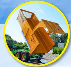
Puerta hidráulica en 1 pieza con junta de goma y cilindros integrados en los brazos de la puerta
